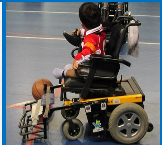
2) Fauteuil électrique équipé d'un pare-choc pour la pratique du foot-fauteuil.
